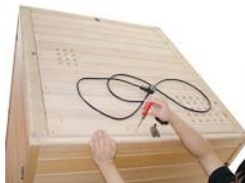
Obr.-23 Upevněte vnější horní kabel pomocí šroubů
