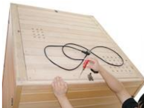
Obr.-23 Upevnite vonkajší horný kábel pomocou skrutiek
