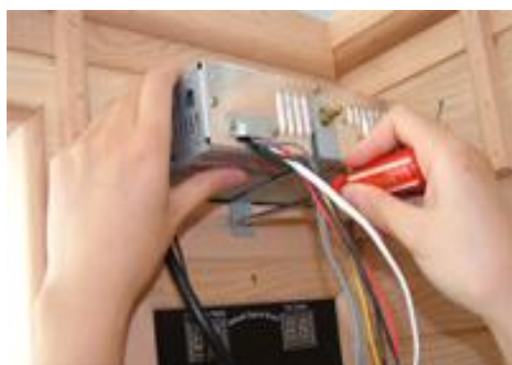
Obr.-16.2 Pripevnenie prehrávača ku kovovej opore opore
